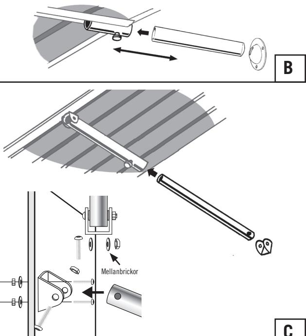
3: Fäst plattformen provisoriskt med en självgående skruv (a) i ett av hålen, fixera plattformen mot akter med hjälp av lina i pulpit. Flukta in linjen mot skrov och däck så att plattformen hamnar rakt. Fäst universalbeslagen med bultar (b) i skrovet. Ta bort skruven (a) och fäst sista bulten i varje beslag. Täta med Sikaflex.
