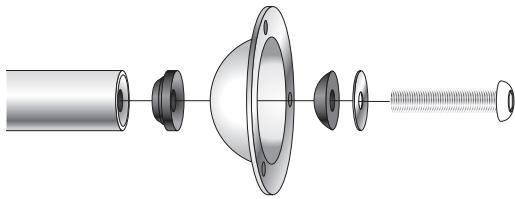
1: Kontrollera att alla delar finns med. Fäst universalbeslagen på plattformen. Skruva fast lagom så att de kan justeras mot akterspeglar.
